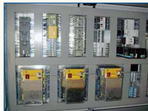
Een besturingspaneel voor een excenter persinstallatie met beveiligings-plc's.
